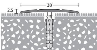
Übergangprofile schaffen Übergänge zwischen nahezu beliebigen, gleichhohen Bodenbelägen. Die in verschiedensten Breiten, Formen, Materialien und Farben erhältlichen Profile lassen sich schnell und unkompliziert verlegen.
