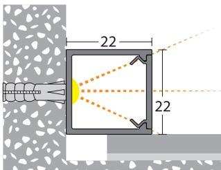
LUXline ist ein PET-Kanal für den Boden-, Wand- oder Deckenbereich – je nach dem wo LED-Beleuchtung gewünscht wird. Darüber hinaus ist er perfekt kombinierbar mit Sockelleisten, die eine Bodenabdeckbreite von 19 – 22 mm haben.
